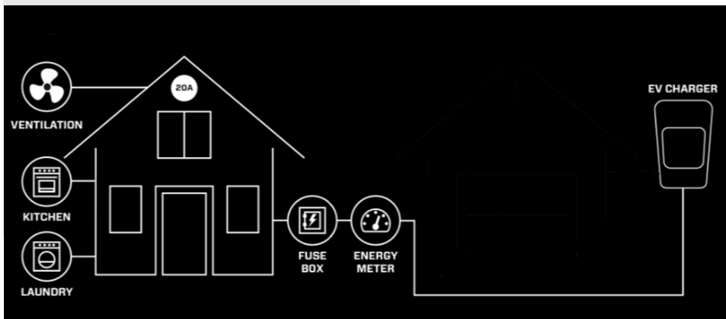
Bild 1. Förklaring av hur lastbalansering mot hemmet fungerar. Energimätaren mäter ständigt husets totala förbrukning, och balanserar – och fördelar – dynamiskt laddstationen efter hur mycket tillgänglig ström som finns i förhållande till huvudsäkring.
